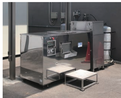
東急ハーヴェストクラブに導入されている コンポスト「バイオクリーン」では生ゴミの85%を減量することが可能。
